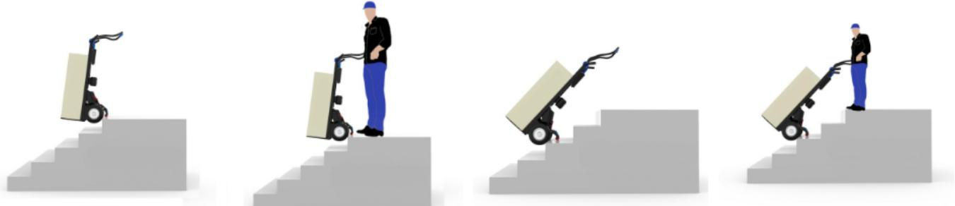
Indirizzando il carrello di fronte alla scalinata, selezionare la modalità che predisponde il carrello alla discesa: le ruote si posizionano automaticamente in prossimità dello scalino, in modo da evitare il ribaltamento del dispositivo, il quale bloccandosi si troverà nella corretta posizione di discesa.
