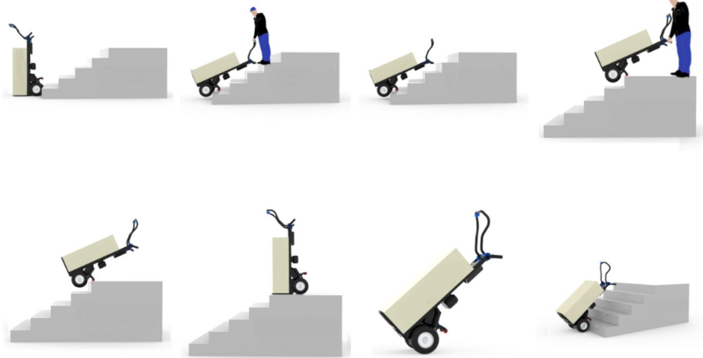
Come la discesa, anche la salita necessita di poche, semplici mosse: selezionare la modalità salita, impostare la velocità, posizionare il dispositivo di fronte allo scalino e il timone in una delle modalità più adatte. Inclinando il dispositivo e premendo il pulsante di movimentazione, il ciclo di salita verrà attivato e l'unico compito sarà quello di tirare a sè il carrello a ogni gradino successivo.
