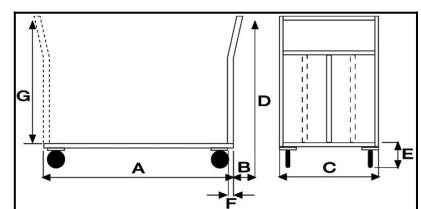
Manico di spinta in tubolare tondo con 3 traverse di contenimento
