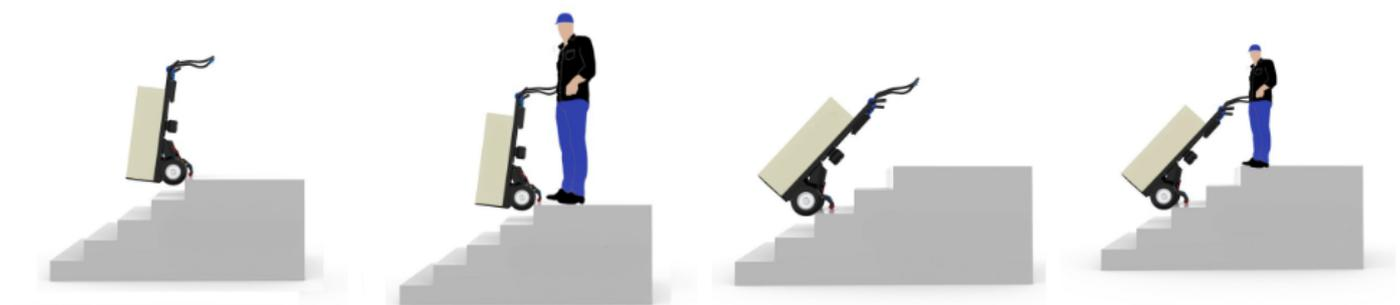
Indirizzando il carrello di fronte alla scalinata, selezionare la modalità che predispone il carrello alla discesa: le routine si posizionano automaticamente in prossimità dello scalino, in modo da evitare il ribaltamento del dispositivo, il quale bloccandosi si troverà nella corretta posizione di discesa.
