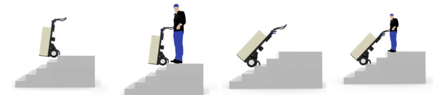
Indirizzando il carrello di fronte alla scalinata, selezionare la modalità che predispose il carrello alla discesa: le routine si posizionano automaticamente in prossimità dello scalino, in modo da evitare il ribaltamento del dispositivo, il quale bloccandosi si troverà nella corretta posizione di discesa.
