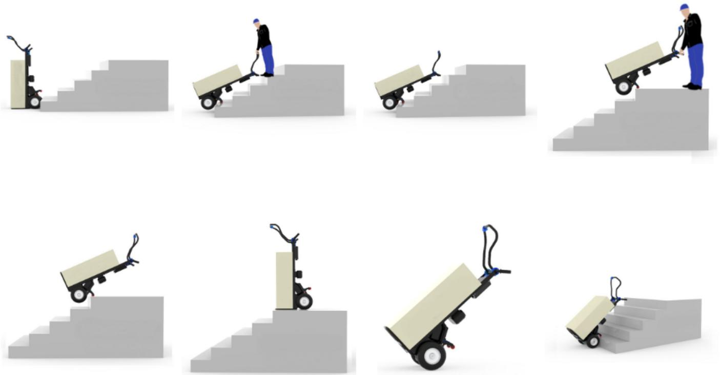
Come la discesa, anche la salita necessita di poche, semplici mosse: selezionare la modalità salita, impostare la velocità, posizionare il dispositivo di fronte allo scalino e il timone in una delle modalità più adatte. Inclinando il dispositivo e premendo il pulsante di movimentazione, il ciclo di salita verrà attivato e l'unico compito sarà quello di tirare a sé il carrello a ogni gradino successivo.
